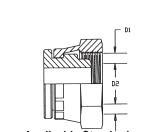
Applicable Standards Thread Form: DIN 2353 DIN 3861 DIN-3901 DIN 3902
